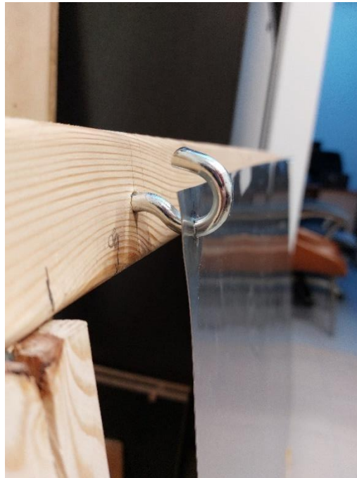
Rysunek 1. Zawieszenie płyty w stanowisku pomiarowym
