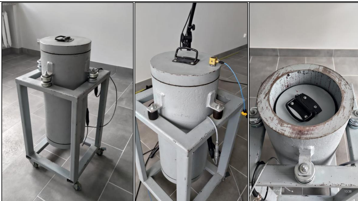
Rys. 1. Widok na urządzenie do pomiaru szumów mikrofonów oraz sytuacja pomiarowa
