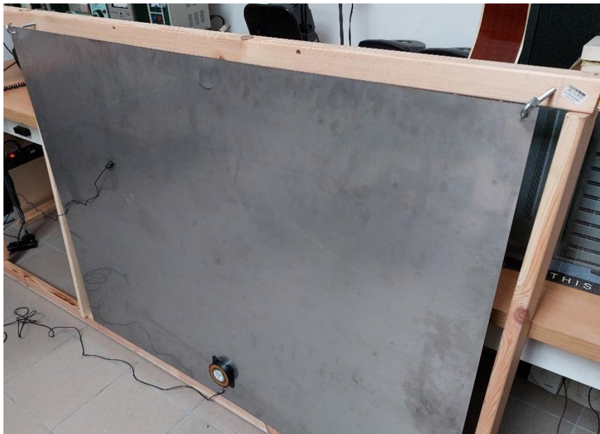
Rysunek 2. Płyta wykorzystana w pomiarach z zamocowanym przetwornikiem elektrodynamicznym oraz mikrofonem kontaktowym.
